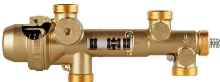
Der „H-PM-Regler“ hydraulische Proportionalmengenregler ist das Herzstück unserer Wohnungsstationen. Er regelt die hydraulischen Volumenströme zwischen Warmwasser- und Heizungsbetrieb. Die PULSON Wohnungsstationen verarbeiten den H-PM-Regler der Firma Bruse. Die Bruse GmbH & Co. KG ist einer der deutschen Marktführer mit 140-jähriger Tradition in Messingverarbeitung.
